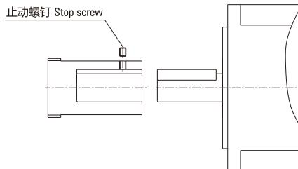
电机轴没有螺孔 No screw motor shaft
