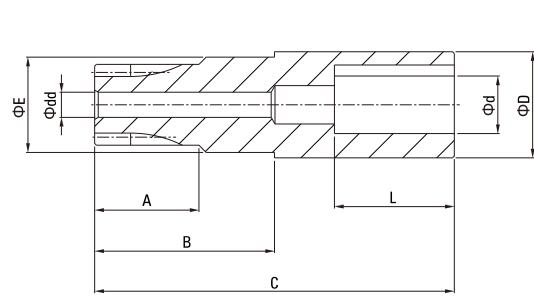
(输入齿轮轴B型 B type of input gear shaft)
