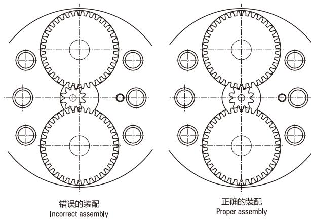
● 图C.8: 不能贯通减速器内部的速比安装示例
