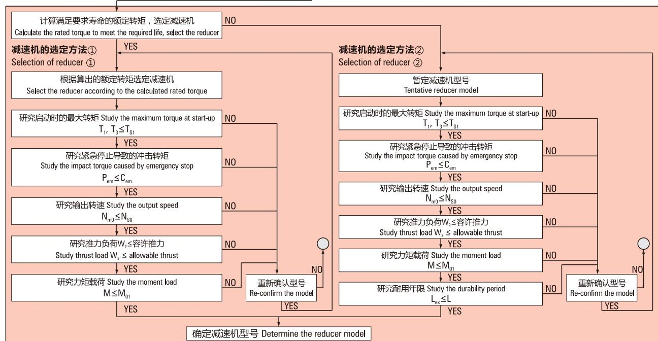
根据选定的减速机的瞬时最大容许转矩，限制电动机的转矩值。
