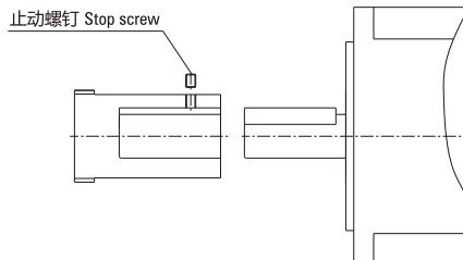
电机轴没有螺孔 No screw motor shaft
