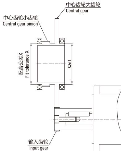
● 表D.4: 中心齿轮、输入齿轮的精度 Table D.4: Center gear, input gear precision
